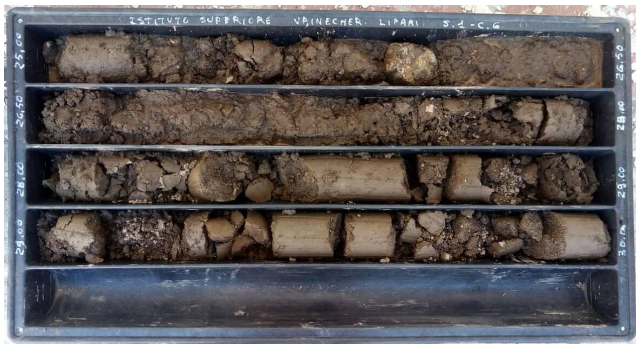
Foto 9: Sondaggio S1 - Cassetta catalogatrice n°6 da 25,00 a 30,00 m
