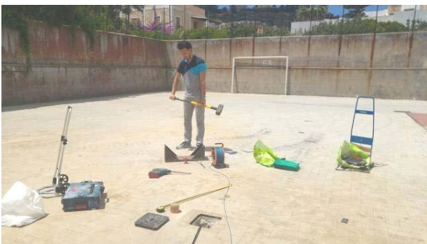
Fase di esecuzione della prova down hole presso il cantiere di Lipari.
