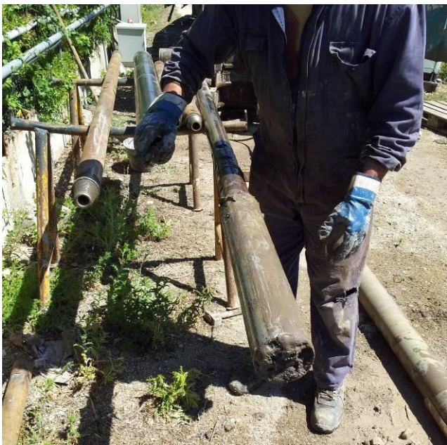
Foto 10: Campionatore a pareti sottili impiegato per il prelievo di campioni indisturbati.
