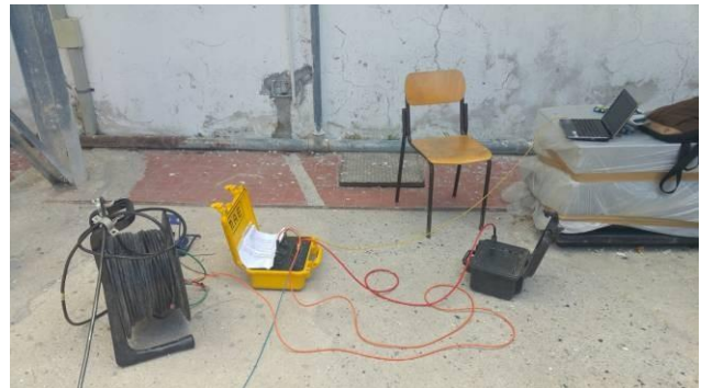
Fase di esecuzione della prova down hole presso il cantiere di Lipari.
