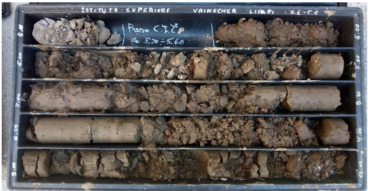
Foto 5: Sondaggio S1 - Cassetta catalogatrice n°2 da 5,00 a 10,00 m
