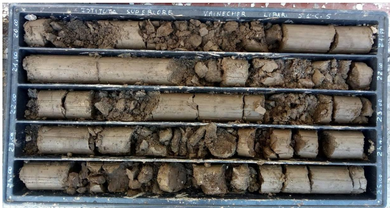
Foto 9: Sondaggio S1 - Cassetta catalogatrice n°6 da 25,00 a 30,00 m
