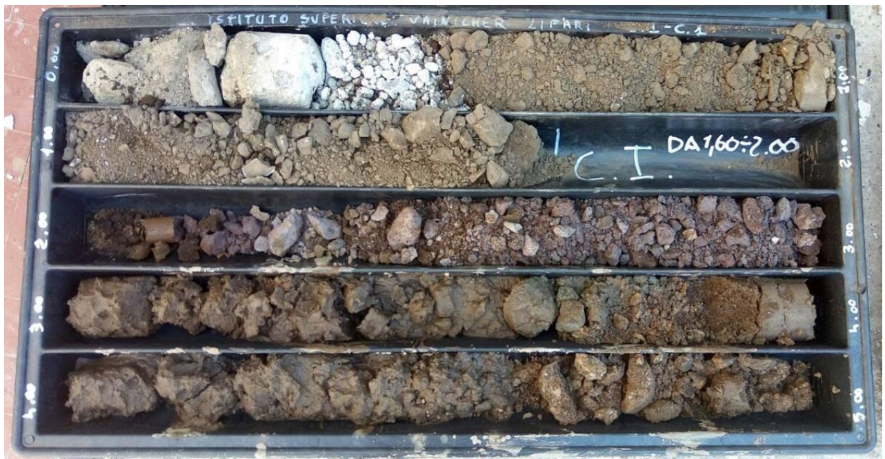
Foto 5: Sondaggio S1 - Cassetta catalogatrice n°2 da 5,00 a 10,00 m
