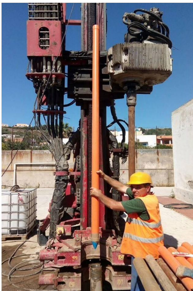
Foto 11: A sinistra, fase di installazione della tubazione in pvc per la prova down hole; in alto, pozzetto di protezione carrabile installato per la protezione della tubazione installata.
