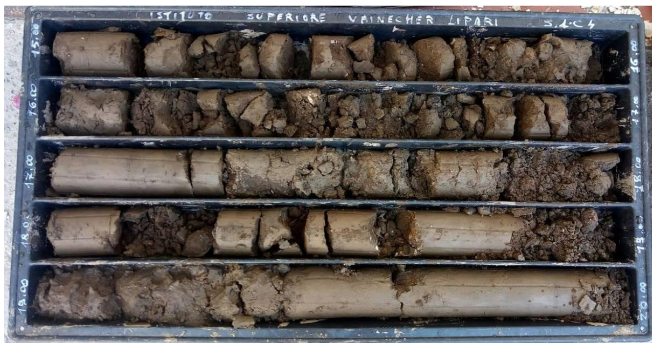
Foto 7: Sondaggio S1 - Cassetta catalogatrice n°4 da 15,00 a 20,00 m
