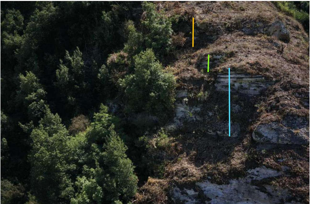
Foto 4 - Vista del tratto inferiore del versante NE. Sono ubicate orientativamente le scanline 5 (arancio), 6 (verde) e 7 (celeste). (Foto da drone per concessione dell'ing. Barone).
