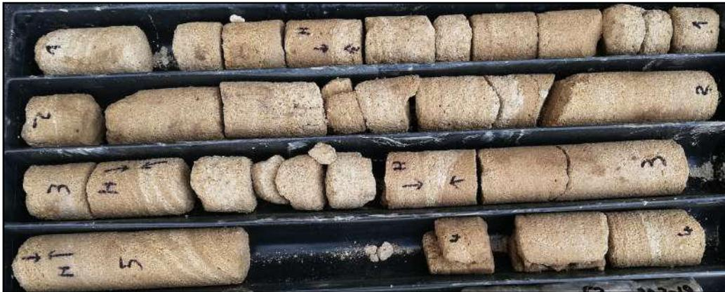
FOTO 02: CAROTE PRELEVATE PER LE PROVE DI TAGLIO CON CELLA DI HOEK
