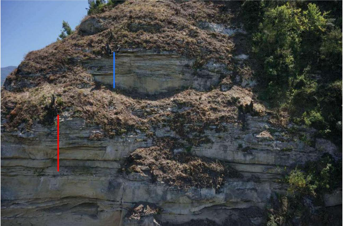
Foto 3 - Vista del tratto inferiore del versante NW, Sono indicate le scanline 2 (blu) e 3 (rossa). (Foto da drone per concessione dell'ing. Barone)
