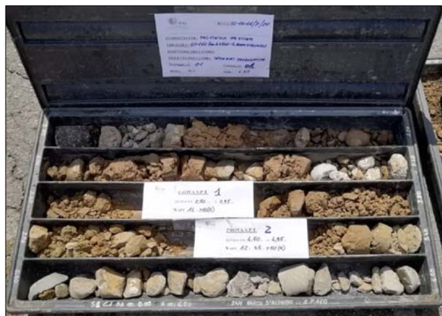
Foto 2: Sondaggio S1 - Cassetta 1 da 0,0 a 6,8 mt
