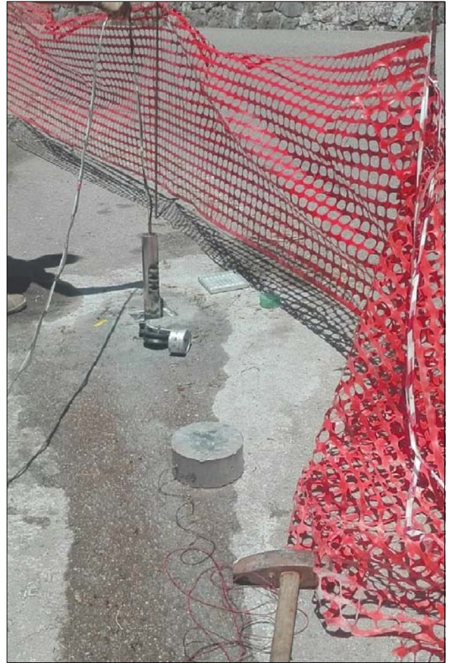
Foto 7: Prova Down Hole
