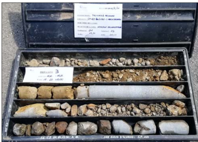
Foto 4: Sondaggio S1 - Cassetta 3 da 13,5 a 20,0 mt
