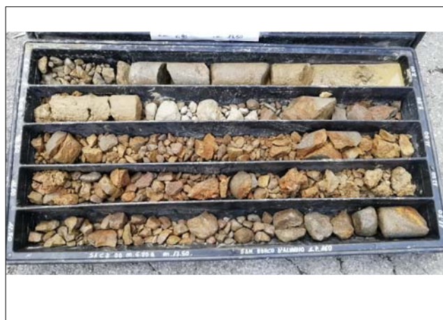
Foto 3: Sondaggio S1 - Cassetta 2 da 6,8 a 13,5 mt
