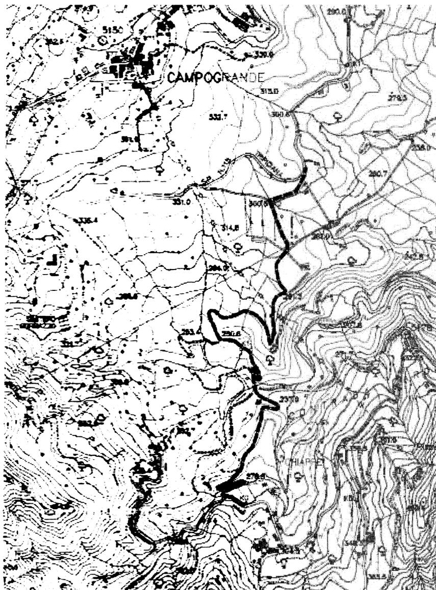
termina, dopo 2+161 chilometri in contrada "Piano" alla progressiva Km. 4+150 della s.p. 115. La strada ha una pendenza media del 0,93% e si sviluppa a mezza costa con rilevante tortuosità.
