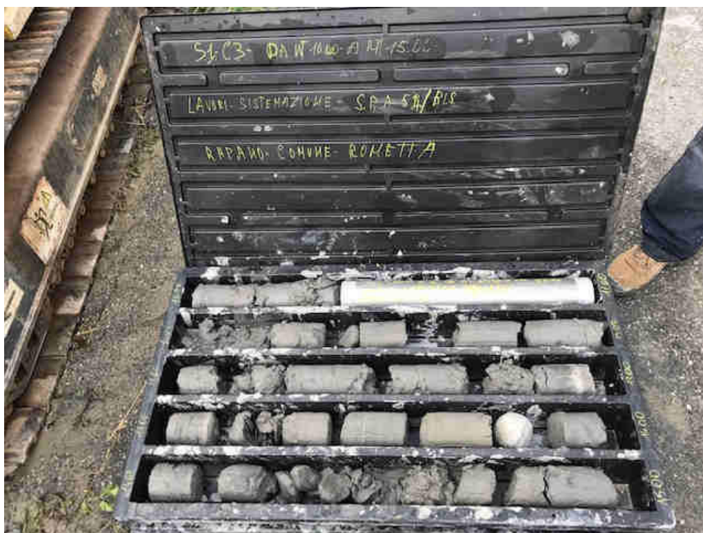
Sondaggio S1– Cassetta n° 3 (da mt. 10,00 a mt.15,00)
