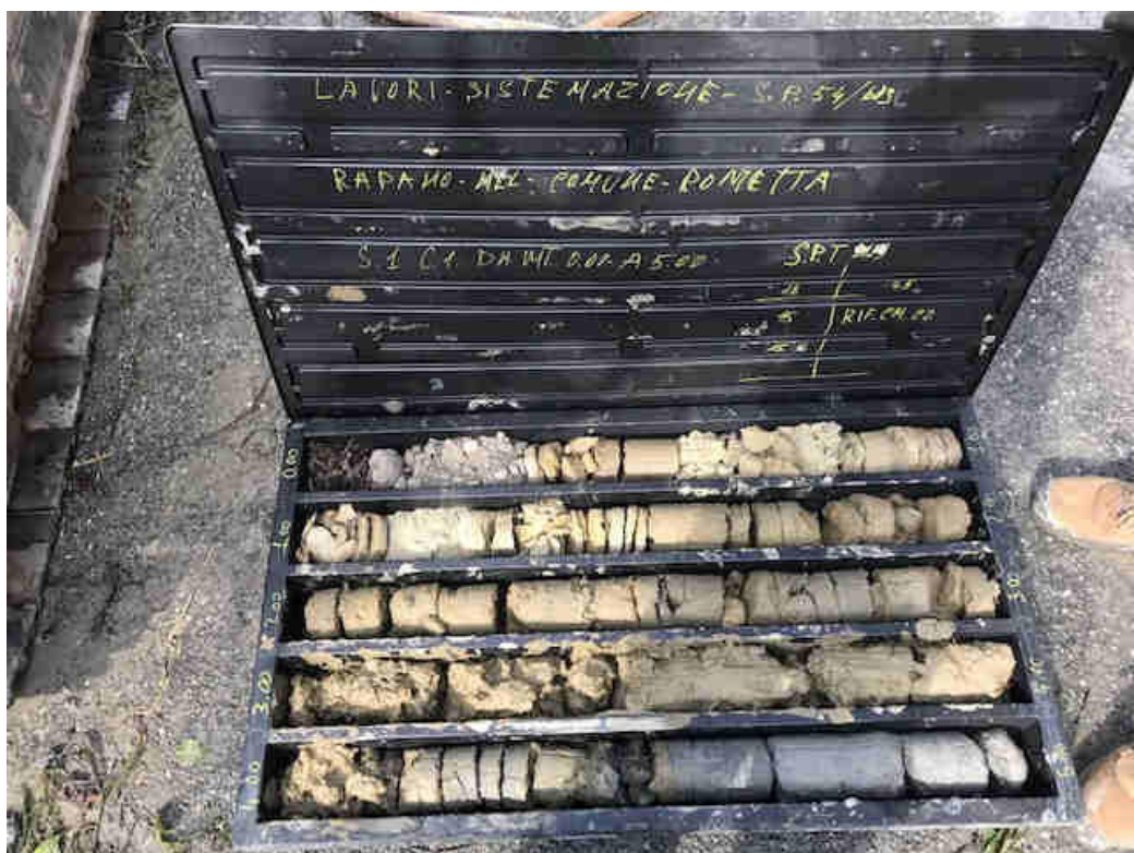
Sondaggio S1– Cassetta n° 1 (da mt. 0,00 a mt.5,00)
