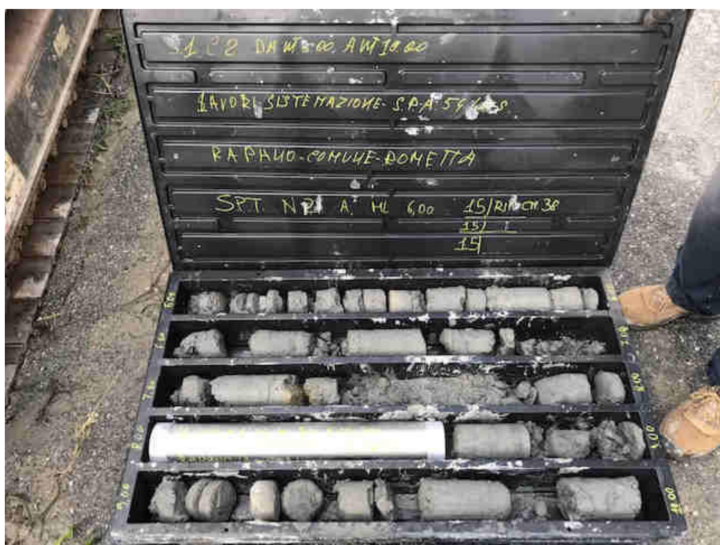
Sondaggio S1– Cassetta n° 2 (da mt. 5,00 a mt.10,00)
