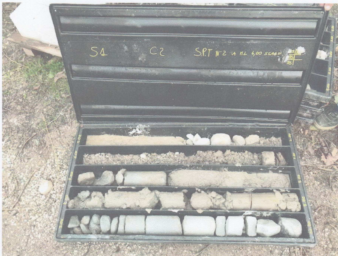
Sondaggio n° 1– Cassetta n° 2 (da mt. 5,00 a mt.10,00)
