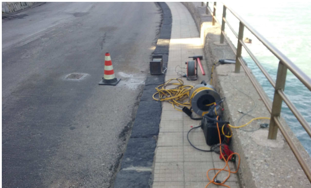
FIG. 03 - ESECUZIONE DELLA PROVA DOWN-HOLE
