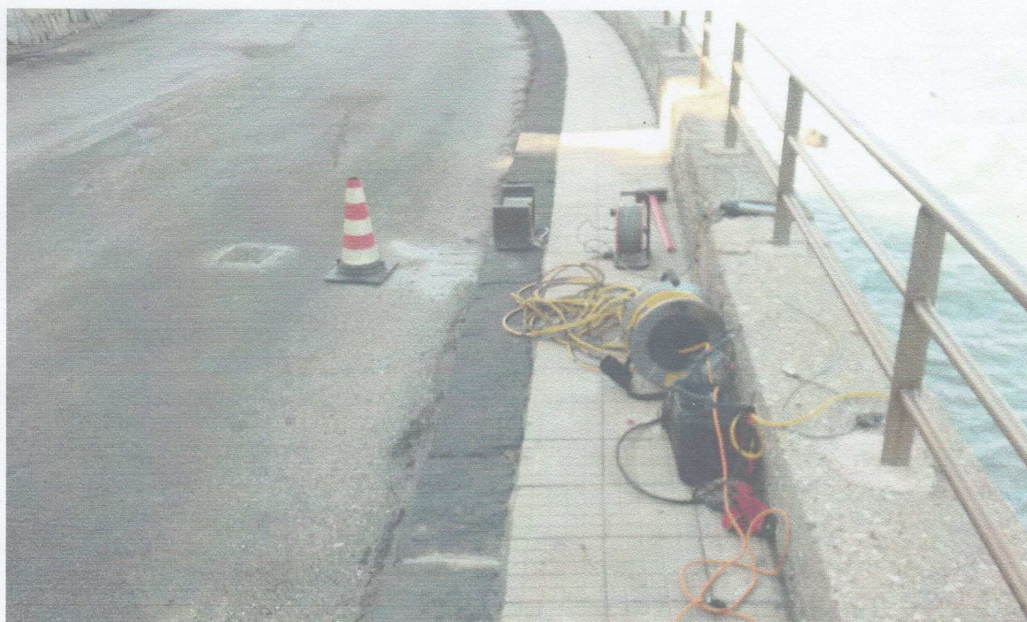
Fasi esecutive della prova Down-Hole
