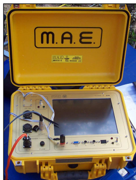
FIG. 01 – SISMOGRAFO UTILIZZATO MAE A6000S
