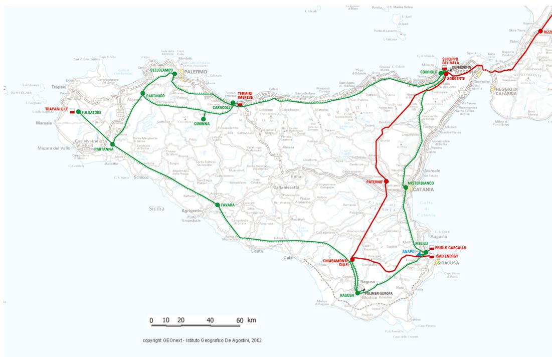
Figura 17 - Stato della Rete elettrica italiana (380kV - 220kV) nel territorio regionale; in rosso la rete a 380 kV e in verde quella a 220 kV (fonte: Regione Siciliana)
